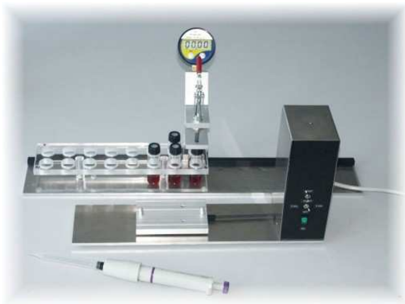
Fig 69. Equipo ViniTest para la determinación de azúcares y ácido málico.
