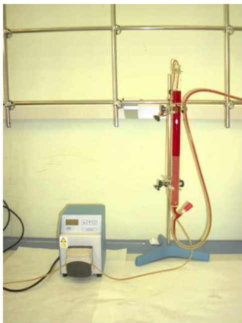
Fig 84. Detalle del dispositivo experimental empleado en los ensayos de intercambio iónico.
