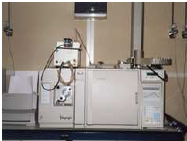
Fig 28. Equipo GC-MS Voyager del SCCYT de la Universidad de Cádiz.
